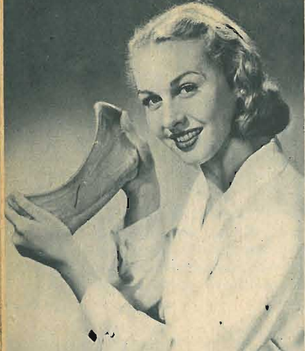
PLASTICITÀ: il silicone, o mastice elastico, può essere impastato facilmente come un mastice comune.
