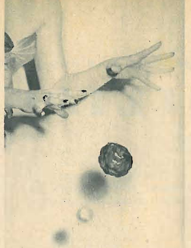
ELASTICITÀ: Quando cade, il silicone rimbalza più in alto delle migliori palle di gomma (U. S. Rubber Co).
